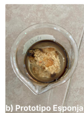
Figura 5. Pruebas de absorción: a) prototipo de esponja b) cáscaras secas sin triturar, c) cáscaras secas trenzadas, y d) polvo de cáscaras secas.
